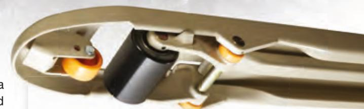
Los rodillos, los deslizadores y el diseño afilado de las puntas de horquilla **optimizan** la entrada y salida a pallets.
